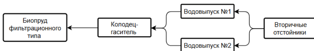
Рисунок 3.2.2 - Предлагаемая технологическая схема Биопруда
